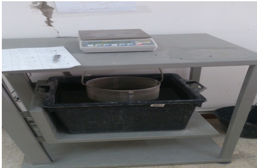
Figure (IV.21): Le dispositif expérimental de mesure de la porosité
