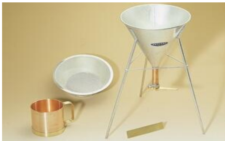
Figure (IV.6) : Essai de détermination de la masse volumique apparente.
